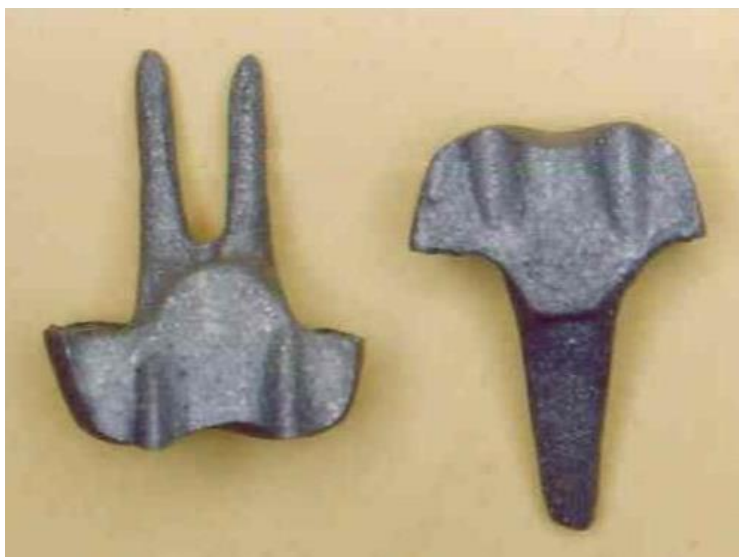
Rasm 33. Yig'ma quyma cho'girli o'zakli tishning «qistirmaning ichida qistirma» shakli.
