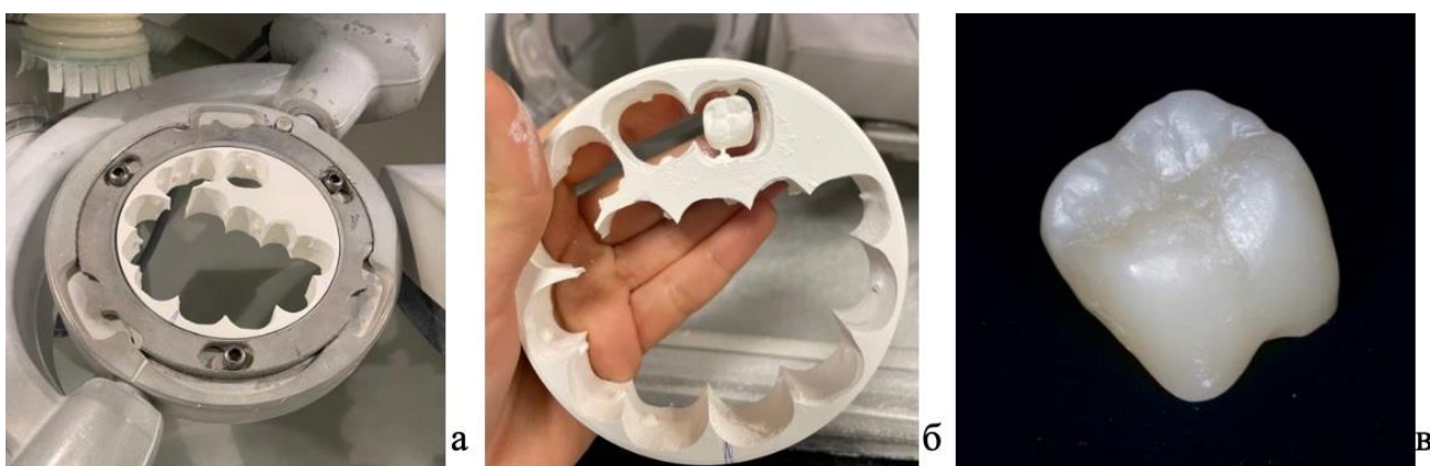
Rasm 24. Koplamani frezerlash: a –frezer apparatidagi blok, b – blokda frezirlangan qoplama, v – pishirishdan keyingi qoplama.
